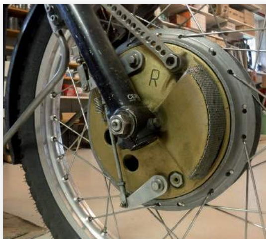
Ceriani 230mm 4 leading shoe voornaaf rechter- en linkerkant. Daarboven: de remkabel geleiding.
