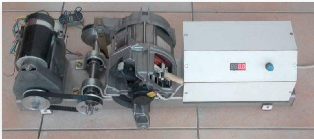
Om de regelaar te kunnen testen heb ik een testbank gebouwd met een wasmachinemotor als aandrijving.
