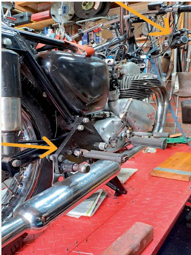
De FH Swingframe constructie bij Aad zijn Square. De pijlen wijzen naar de joekel van een schetsplaat (!) en de hydraulische rem pomp.
