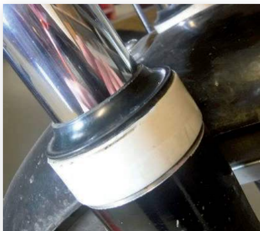
Links en hierboven: de keerringen vervangen en de verdroogde doppen vervangen door moderne vuilafstrijkers
