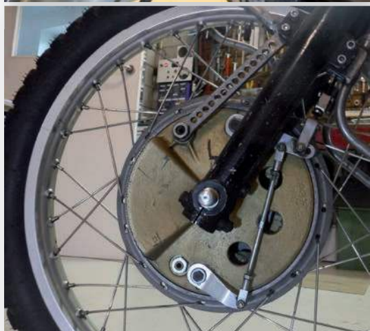
Ceriani 230mm 4 leading shoe voornaaf rechter- en linkerkant. Daarboven: de remkabel geleiding.
